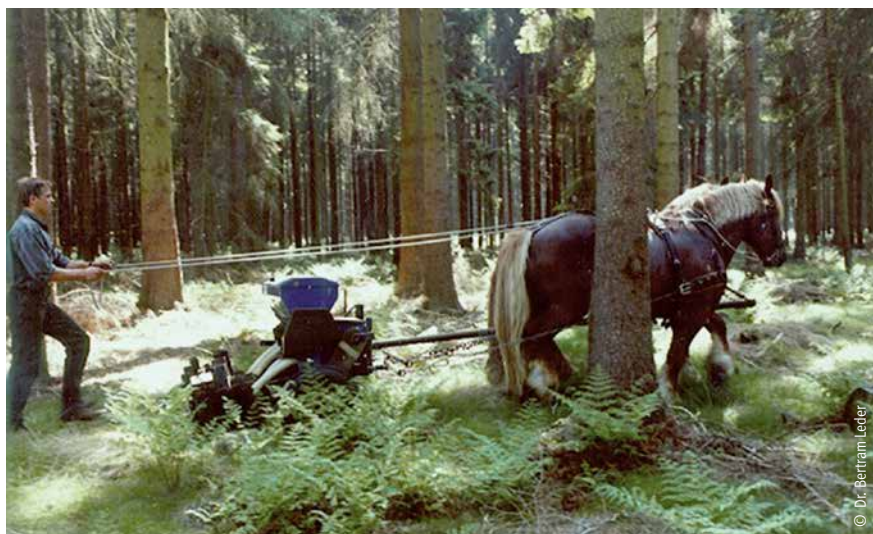
Bild 23: Maschinelle Bucheckernsaat mit Pferdezug
