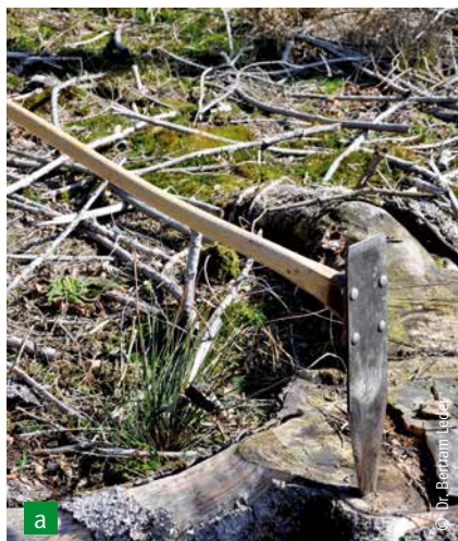
Bild 40a/b: Buchenbühler Schrägpflanzhaue mit Pflanzen-Doppeltragetasche Blattlänge: 425 mm; Blattbreite: 90 mm; Stiellänge: 1.000 mm; Gewicht: 3.250 g; Winkelstellung Blatt zum Stiel: 100 Grad
