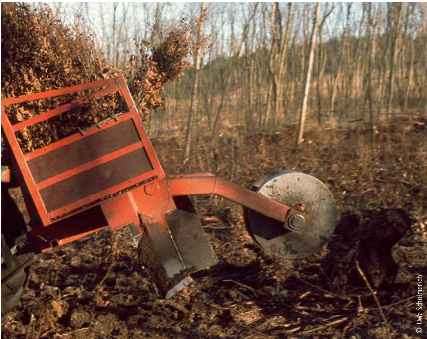
Bild 44: Der Einsatz einer Pflanzmaschine ist kostengünstig, hat aber eine flächige Befahrung zur Folge
