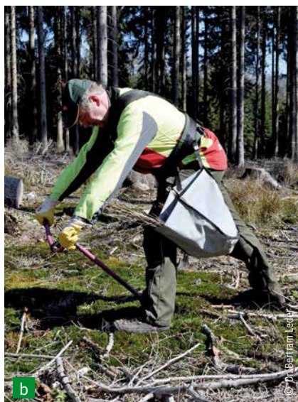
Bild 39a/b: Göttinger Fahrradlenker Blattlänge: 400 mm; Blattbreite: 120 mm; Stiellänge: 1.000 mm; Gewicht: 4.880 g
