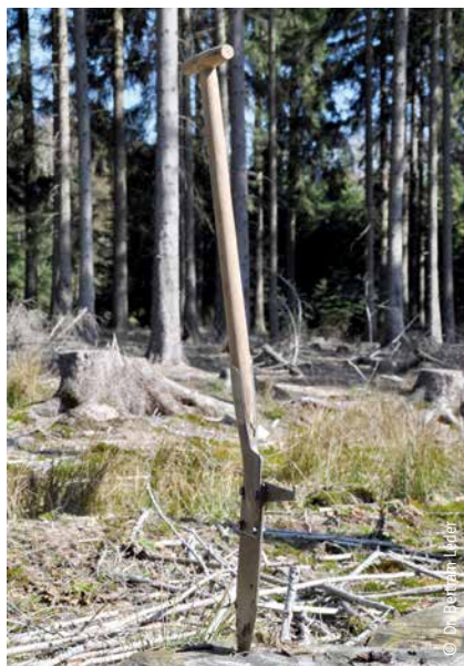
Bild 38a: Pflanzspaten Neheim (FBZ); Blattlänge: 415 mm; Blattbreite: 98 mm; Länge (mit Blatt): 1.225 mm; Gewicht: 3.080 g; Winkelstellung Blatt zum Stiel: 11 Grad
