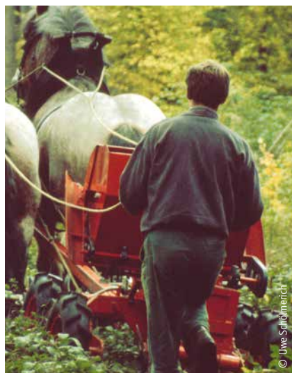
Bild 19: Streifensaart mit pferdegezogener Saatmaschine
