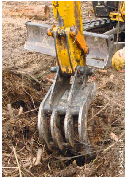
Bild 43: Kombiniertes Pflanzverfahren mit Kleinbagger
