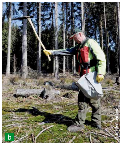
Bild 40a/b: Buchenbühler Schrägpflanzhaue mit Pflanzen-Doppeltragetasche Blattlänge: 425 mm; Blattbreite: 90 mm; Stiellänge: 1.000 mm; Gewicht: 3.250 g; Winkelstellung Blatt zum Stiel: 100 Grad
